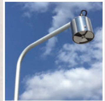
本研究にて 設計・製造した 静電気センサ本体▶
